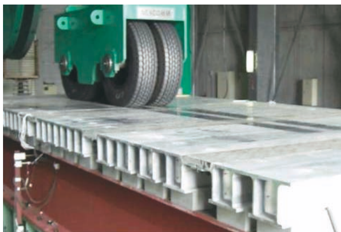
■ 疲労耐久性評価試験(施工技術総合研究所)
