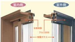
アルプラはそのネーミングの通り、アルミニウムと樹脂によるハイブリッド製品で、アルミサッシの約2倍の断熱性能を有する商品です。風雨にさらされる外側には耐候性と強度に優れたアルミ型材を使用、室内側はアルミに比べ熱伝導率が約1000分の1となる樹脂を使用することにより、外気の影響を押え、框部分の結露を発生しにくくする断熱構造のサッシです。住空間の快適性にくらしの省エネルギーをプラス・ワンした「断熱サッシ・アルプラ70」はまさに21世紀型のアルミ機能建材といえます。
