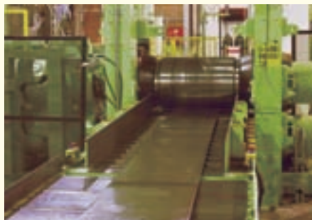
完成した 400 トン熱間圧延機
