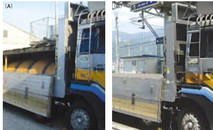
往路(A)は2段フロアーに、復路(B)は通常平ボディにすることにより、各専用車が不要となり車輦数を削減することができます。
