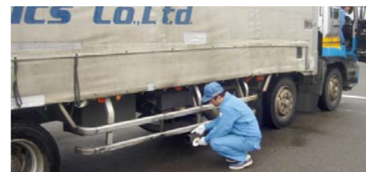
排気ガスチェック
