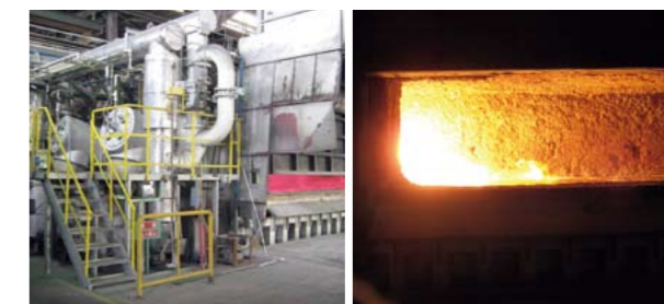
リジェネバーナーを導入した アルミニウム溶解炉
