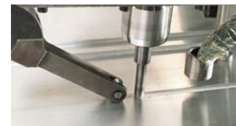
FSWによる接合の様子
