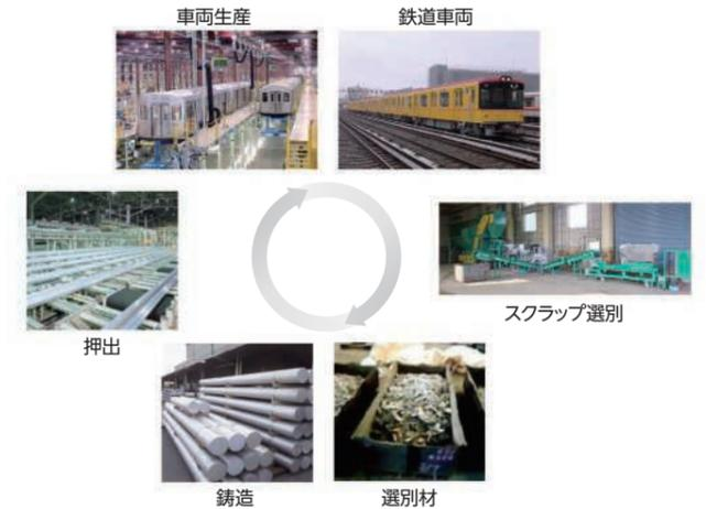
構築を目指すアルミ車両の水平リサイクルシステム
