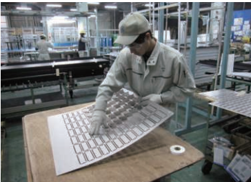
生産補助業務(アルミ部品の取り外し作業)
