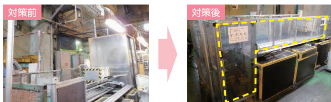
日本軽金属(株)蒲原熱交製品工場の改善例 切断機周辺の安全柵を追加、安全装置を設置した
