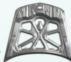
自動車フードインナー材 (フレックスキャスト法で製造した板材)
