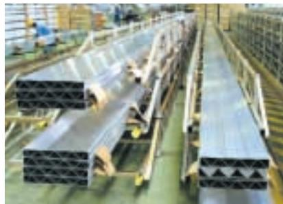
次世代新幹線車両向けに受注した大型アルミ押出型材
