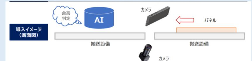
検査システムに係るプロセスを自動化し、品質改善を図る
