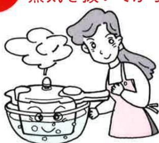
調理後、火を止めても圧力鍋の内部には、まだ圧力が残っています。外気と同じ圧力になるまでは、ふたは開かない構造になっています。必ず圧力が下がったことを確認したうえでふたを開けましょう。
