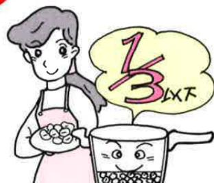
豆類などのように煮ている間にかさの増えるものは、豆と水を合わせた量が(1/3)以下で使用してください。特に大豆のように皮のはがれやすい豆は、付属品の中すを使い、落としふたがわりにしますと皮がノズルに詰まることを防げます。(鍋の内側にマメサイダイのマークが表示されています。)
